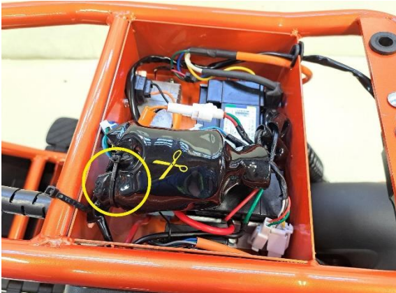
Katkaise johtojen suojaa kiinni pitävä nippuside (sivuleikkurit).
